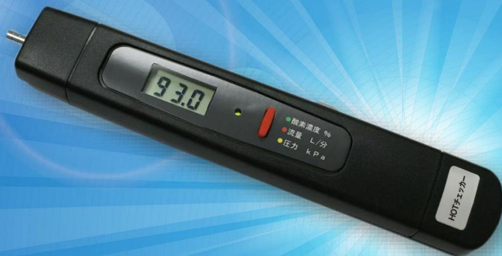
HOTチェッカーは在宅酸素医療用酸素濃縮装置専用の計測器で、酸素濃度、流量、吐出圧を1台で計測します。超音波センサーの採用により校正不要で操作は特別なトレーニングが不要で、簡単にご使用頂ける在宅酸素医療で必須の計測器です。
